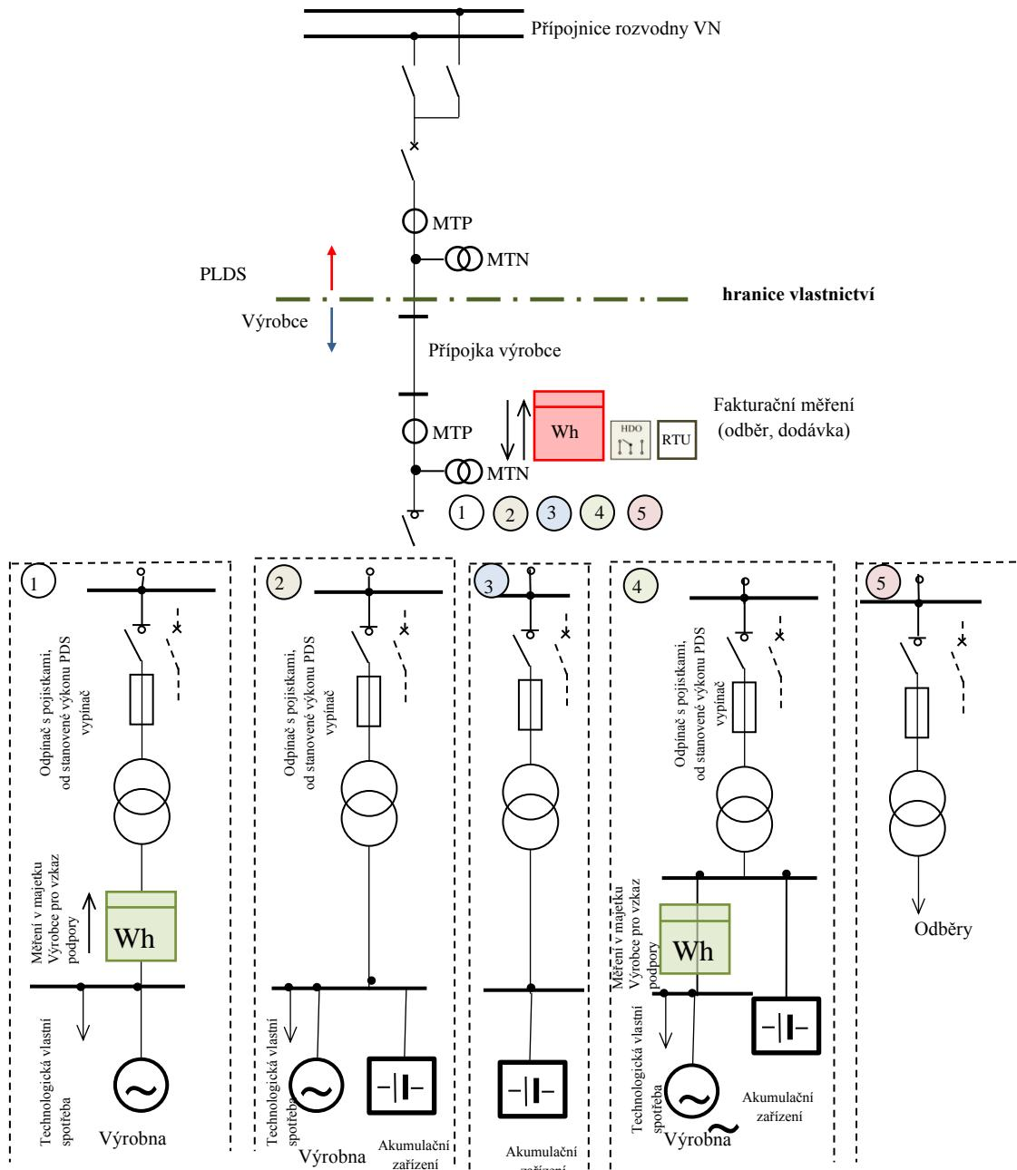
1. Při jednom transformátoru lze osadit i nepřímé měření na jeho sekundární straně.
