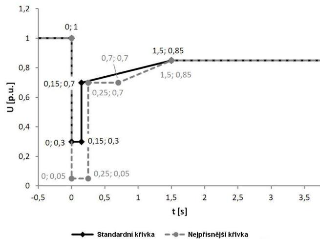
Obr. 3 – Schopnost překlenutí poruchy přímo připojených generátorů
