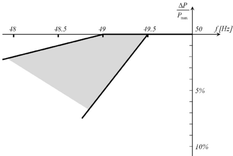
Obr. 6 Maximální snížení činného výkonu s klesajícím kmitočtem.
