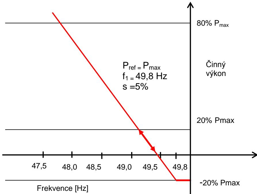
Obr.7 Frekvenční odezva činného výkonu na podfrekvenci u akumulačního zařízení.
