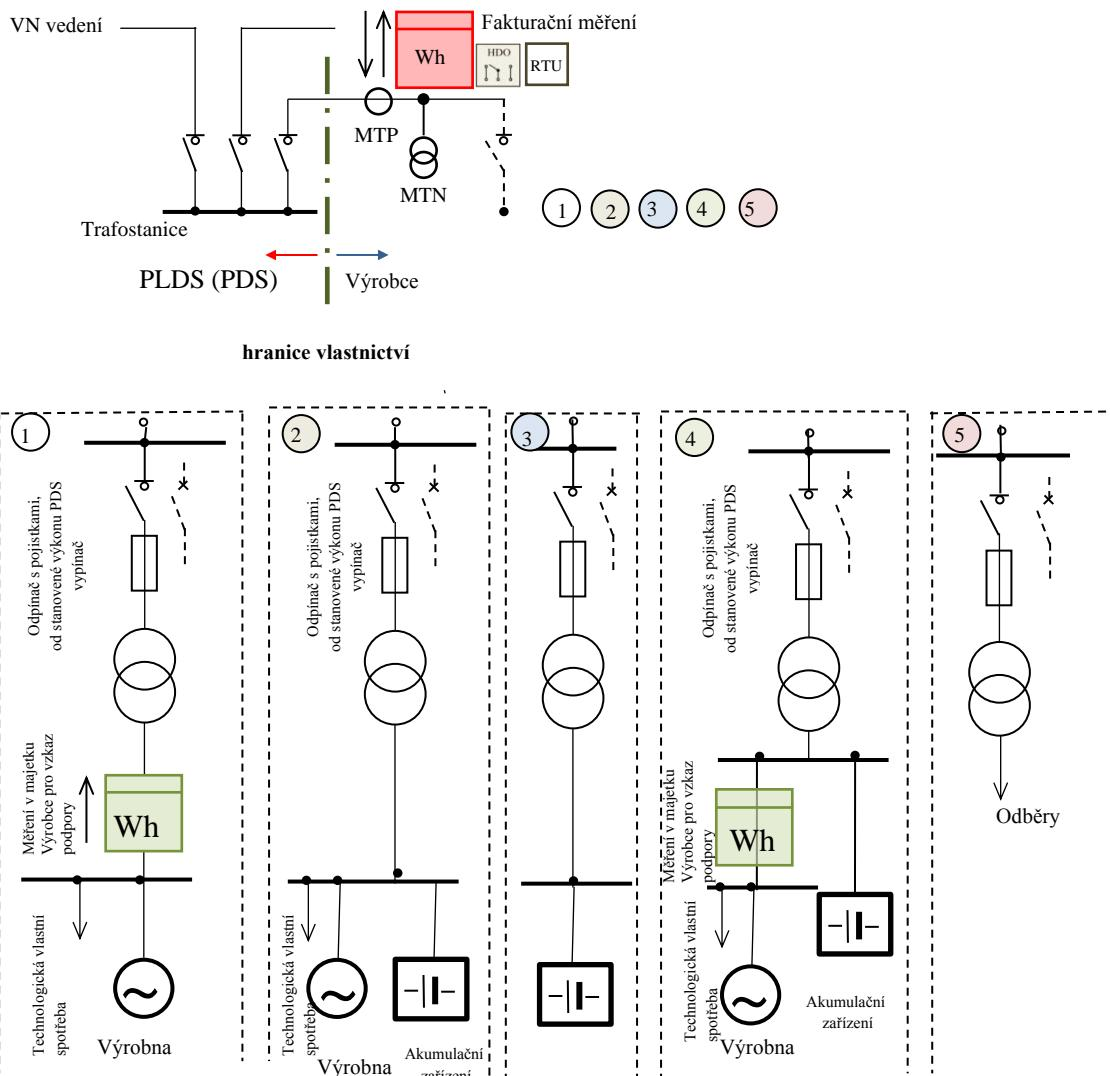
1. Při jednom transformátoru lze osadit i nepřímé měření na jeho sekundární straně.
