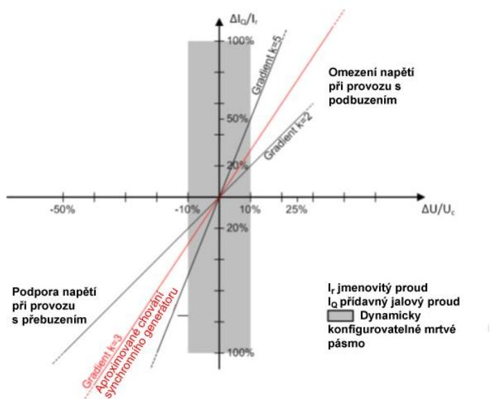
Obr. 4 Princip podpory napětí sítě při poruchách
